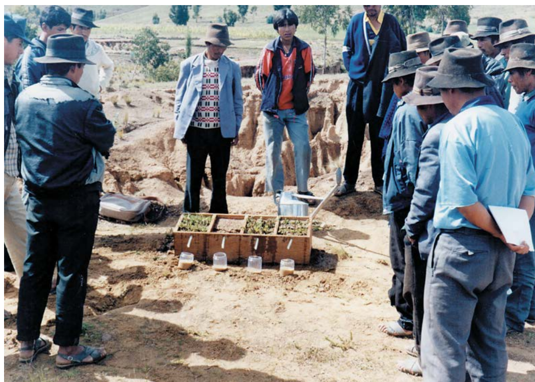
Uso de la caja de erosión para visualizar procesos erosivos de los suelos que no contienen obras de conservación, 1997.
